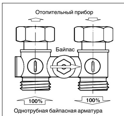
Для настройки потока через радиатор от общего весового расхода воды (пропорциональное распределение) следует пользоваться номограммой для однотрубной системы.
